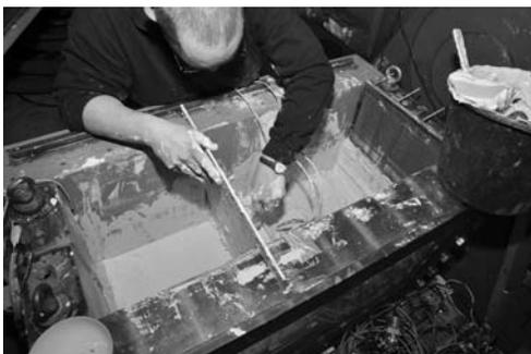
Nach einer Konsolidierungszeit von 12 Stunden im erhöhten Schwerfeld von 50g wird die Zentrifuge gestoppt und der Modellbehälter umgebaut. Dazu werden zunächst die Sandmatten abgenommen und überschüssiges Kaolin abgetragen.
