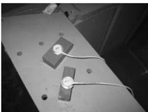
Auf dem Boden des Behälters werden die Messdosen zur Ermittlung der totalen Vertikalspannungen platziert. Die Druckmessdosen haben eine Höhe von 5 mm und sind auf 20 mm hohen Blöcken montiert, so dass sie aus der 20 mm starken Drainageschicht herausragen und die Spannungen an der Unterkante der Weichbodenschicht messen.
