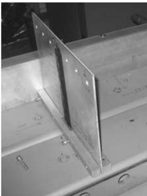
Die Modellwand wird zwischen den Leisten eingespannt und am Boden des Modellbehälter fixiert. Zuvor wurde ein „Wassereinlagerungstest“ durchgeführt, um sicher zu stellen, dass die DMS aufgrund der langen Verweildauer im Wasser nicht ihre Funktionsfähigkeit verlieren. Das Eindrücken oder Rammen der instrumentierten Modellwände durch die Weich- und Drainageschicht beinhaltet die Gefahr, dass die Lagerung nicht richtig getroffen sowie die Messtechnik beschädigt wird.
