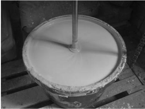
Der Weichboden wird aus einer Schlämme hergestellt, die unter Verwendung eines Kaolinpulvers angerührt wird.
