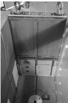
Das Geogitter ist an der Führungs- sowie an der Anschlussstange befestigt. Die Führungsstangen der Lagerung auf der Symmetrieachse werden in die Führungshülsen gesteckt. Die Anschlussstange für die Verbindung des Geogitters mit der Modellwand nach der Konsolidierung wird am oberen Rand des Modellbehälter befestigt.
