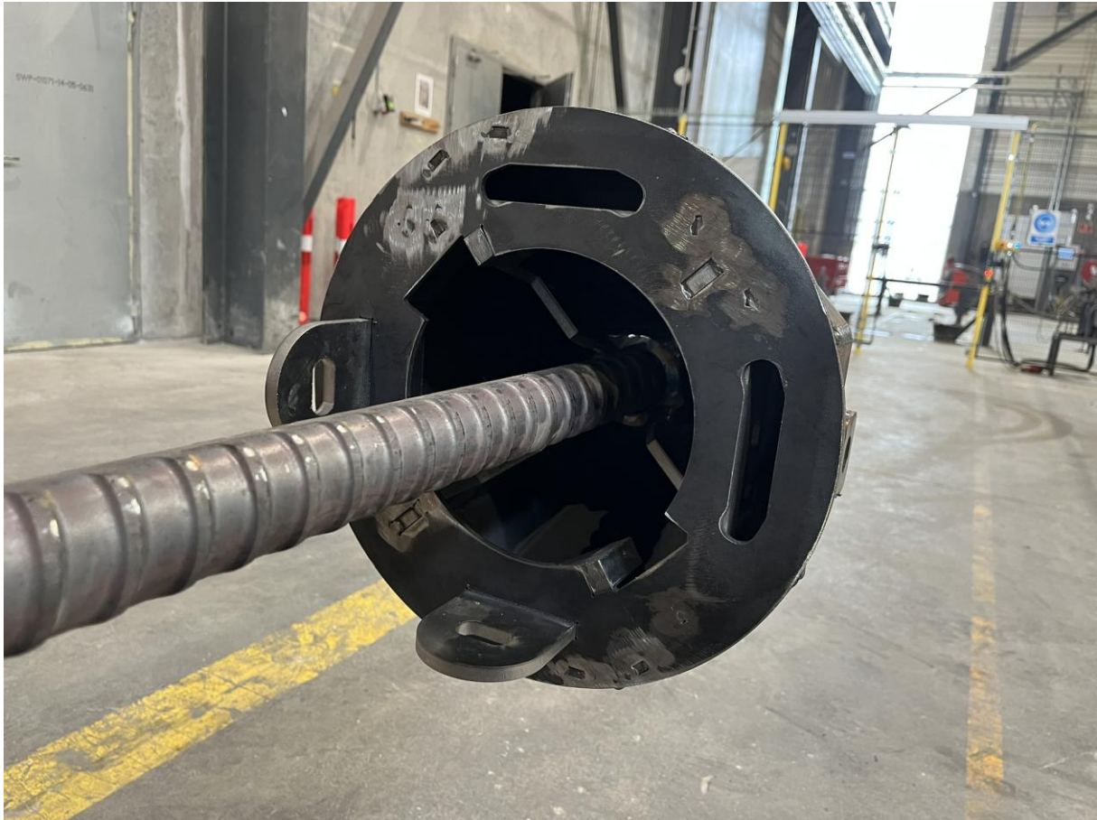
Abbildung 6: Fußspitze mit GEWI-Stab für hohe Zuglasten.
