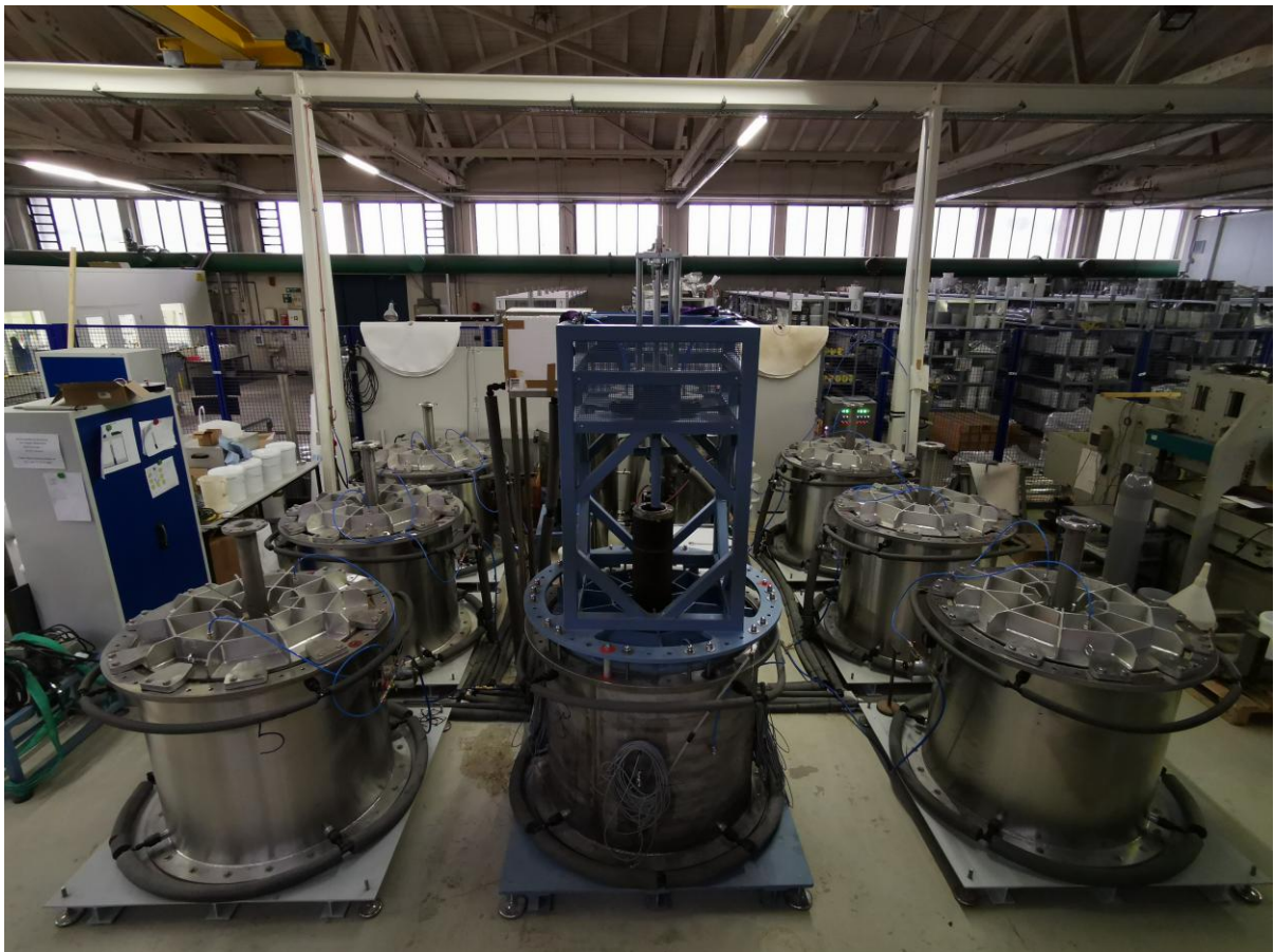
Abbildung 1: Versuchsstand zur Untersuchung des Herauszieh Widerstands von Modellverpressankern (Herten & Heidenreich, 2022).
