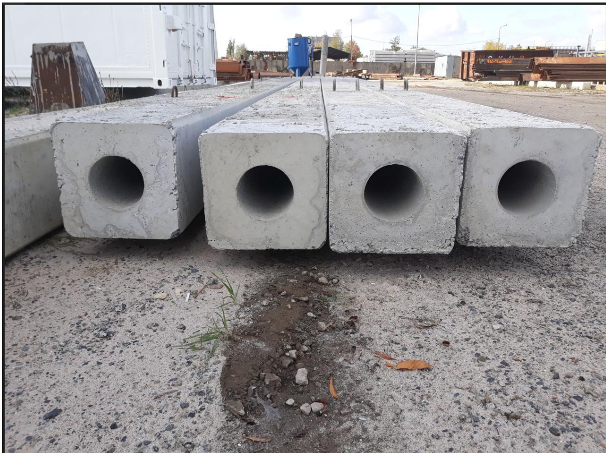
Abbildung 2: Rammpfahl 40/40 cm als Hohlquerschnitt.
