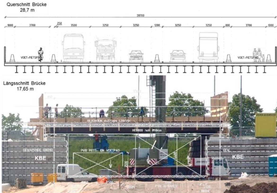
Abbildung 1: Anwendung eines Geokunststoff-Bewehrten-Erdkörpers (KBE) als Widerlager einer Behelfsbrücke (i-Lent, Ruimte voor de Waal, Nijmegen, Niederlande).
