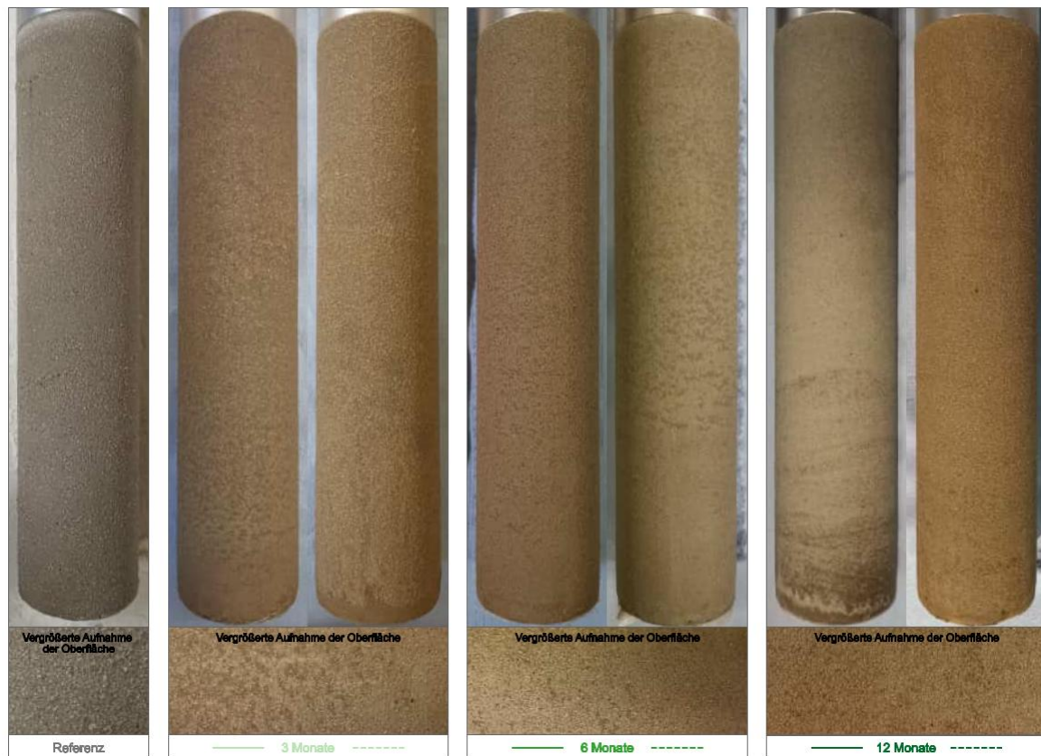
Abbildung 3: Ausgebaute Modellverpressanker nach unterschiedlicher Beaufschlagungsdauer mit kalklösender Kohlensäure.
